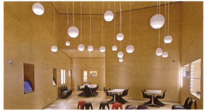
Bambus-Paneele als Verkleidung für Wand, Decke und Boden speziell für die VIP-Lounge entwickelt.
